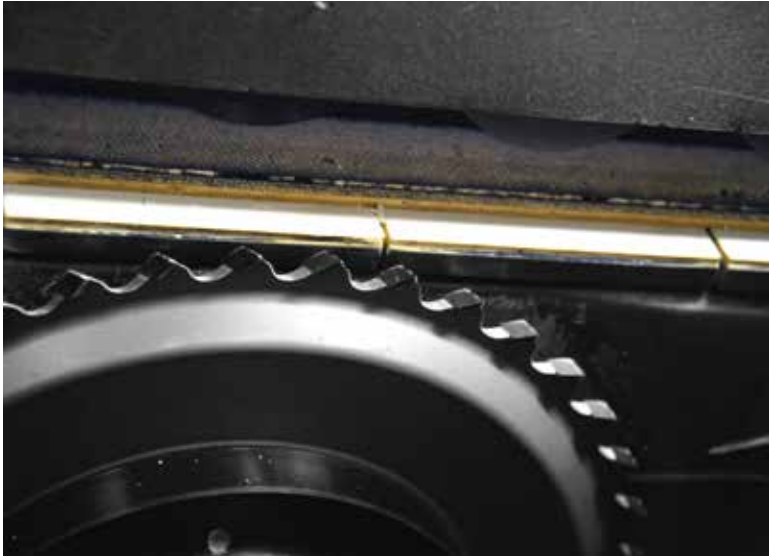
Tiefer Blick in die Maschine: Die spezielle Schneidengeometrie des EdgeExpert ist gut erkennbar
