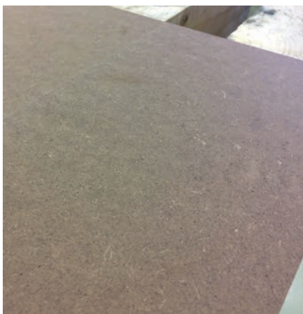
Planfräser HeliPlan: Nahezu riefenfreie Oberflächenqualität beim Abplanen von Opferplatten (links), sowie Oberflächen in Finishqualität bei thermoplastischen Kunststoffplatten (rechts).
