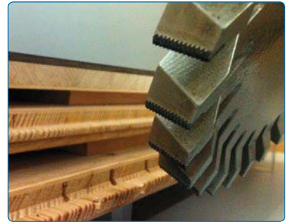
Möbelteile und Fußbodenpaneelen Vorzerspannung beim Profilieren
