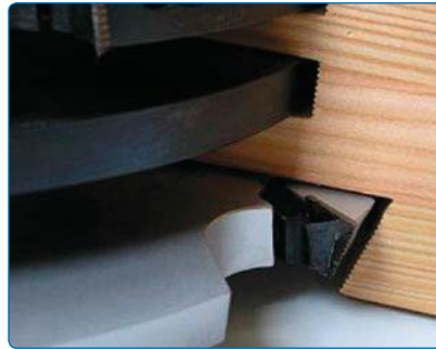
Holzfensterrahmen Schlitz- und Zapfenverbindungen, Konterprofile
